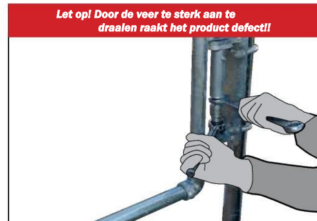
N. Zodra de poort geheel gesloten is, de moer vastdraaien zodat de spanning in stand wordt gehouden. Let op: Blijf de ratel stevig vasthouden en laat deze pas los als de borgmoer is vastgedraaid. Verwijder de dopsleutel en ringsleutel nu van het scharnier. Herhaal de procedure zo nodig totdat de poort goed sluit zodra deze is geopend en wordt losgelaten.
