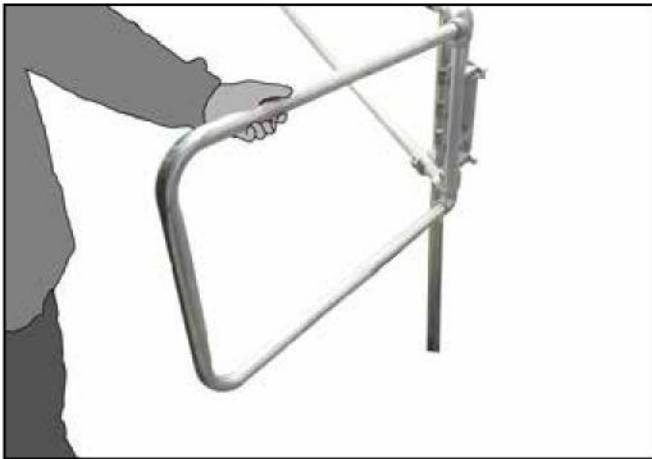
L. Open de poort handmatig tot 45 graden vanuit gesloten positie.
